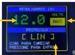
Esta sección muestra el nivel de voltaje de corte (BAJO, NORMAL, ALTO)
